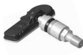
"Illustrasjonsbilde av sensor" Moment mutter 8.0 Nm Moment ventilnål 0.4 Nm
